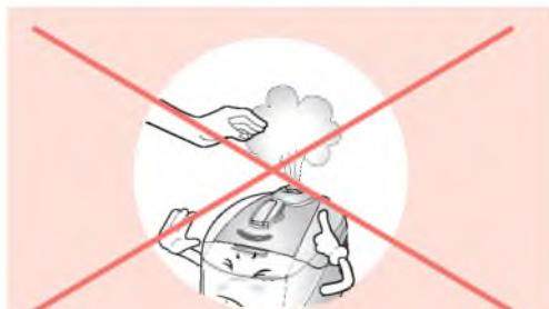
Во время пользования устройством не приближайте руки и лицо к регулятору давления и отверстию для автоматического выпуска пара. Не прикладывайте уши к корпусу мультиварки вблизи выпускного клапана.
