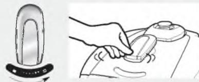
Поверните рычаг затвора в положение «ЗАКРЫТО» – на панели загорится красный индикатор. При попытке запустить мультиварку при открытом затворе «Голосовой гид» оповестит вас об ошибке.
