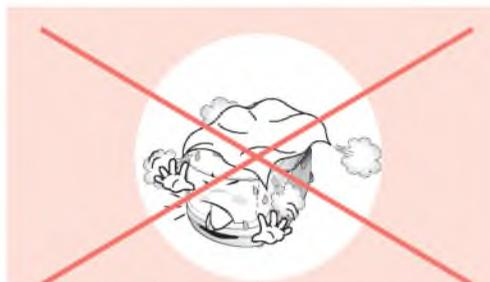
**Не используйте устройство, закрыв или положив что-либо на регулятор давления или отверстие для автоматического сброса пара.**
