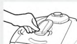
Поверните рычаг затвора в положение «ЗАКРЫТО» – на панели загорится красный индикатор. При попытке запустить мультиварку при открытом затворе «Голосовой гид» оповестит вас об ошибке.
