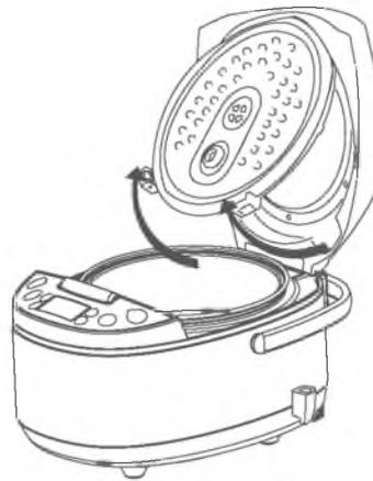
Начисто промийте пластину кришки і ущільнювач водою і витріть насухо. По закінченню, поверніть внутрішню кришку на своє місце. Для цього помістіть верхню напрямну в паз і притисніть пластину до зовнішньої кришки до клацання фіксаторів.
