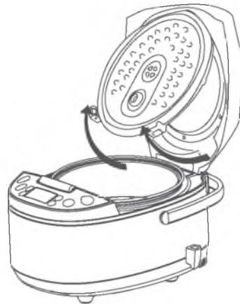
Начисто промойте пластину крышки и уплотнитель водой и вытрите насухо. В завершении, верните внутреннюю крышку на своё место. Для этого поместите направляющую в паз и прижмите пластину к внешней крышке до щелчка фиксаторов.
