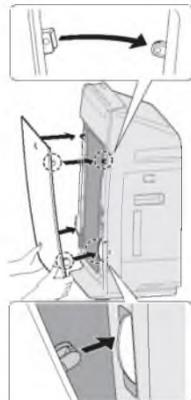
※ Проверьте, чтобы передняя панель была установлена перед началом работы.
