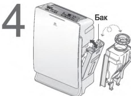
Верхнее положение и нижнее положение бака должны поменяться при заполнении его водой и установке его обратно.
