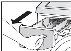
2. Извлеките отсек для моющих средств, вытягивая его наружу и одновременно нажимая на середину крышки резервуара для смягчающих средств.
