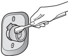
7. Если прибор укомплектован шлангом с клапаном подачи воды, перекройте кран, отсоедините шланг от крана подачи воды, затем прочистите фильтр на шланге, выполнив те же действия.
