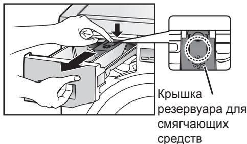
3. Потяните пальцем лапку рядом с передней частью крышки резервуара для смягчающих средств, чтобы извлечь резервуар из отсека.
