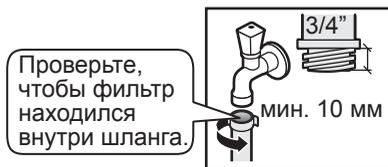
3. Медленно откройте кран и проверьте, нет ли течи воды в местах соединения. Места соединения подвержены давлению воды.
