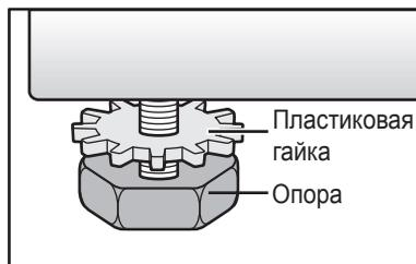
1. Ослабьте пластиковые гайки на каждой опоре, вращая по часовой стрелке.
