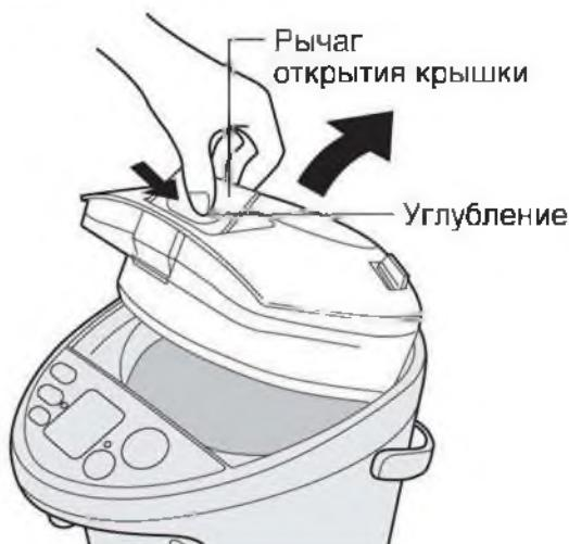
**Нажмите на разблокиратор крышки, держа за рычаг, потяните крышку вверх по диагонали.**
