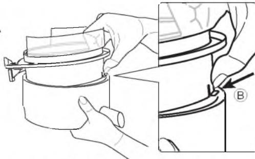
② Нажмите В на выступ-фиксатор и, придерживая его, поднимите верхнюю часть, вынув ее из нижнего корпуса.
