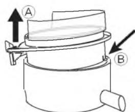
① Потяните верхнюю часть А поворотного контейнера пока не появится выступ-фиксатор В (см. рисунок).
