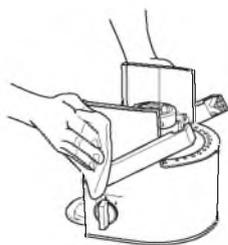
Протрите корпус двигателя влажной тряпкой.
