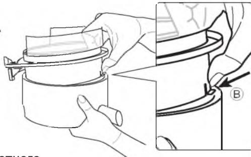
② Натисніть на виступ-фіксатор В і утримуючи його, підніміть верхню частину, вийнявши її з нижнього корпусу.
