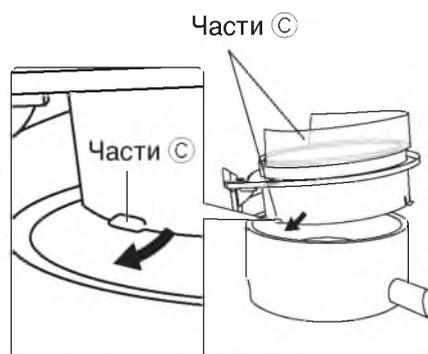
③ Для сборки блока для контейнера сначала установите Части С, затем, нажав на выступ-фиксатор В, опустите верхнюю часть в нижний корпус.
