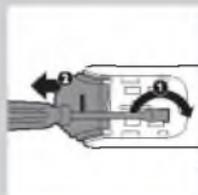
3 С помощью отвертки с плоским шлицем снимите кнопку включения/выключения.
