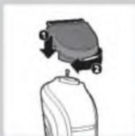
1 Установите триммер на ручку (1) и поверните его по часовой стрелке для фиксации (2).
