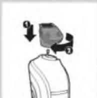
**1** Установите высокоточный триммер на ручку (1) и поверните его по часовой стрелке для фиксации (2).
