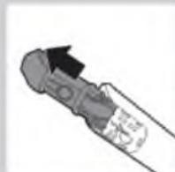
4 С помощью отвертки с плоским шлицем снимите с прибора лицевую панель.
