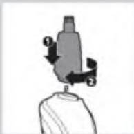
**1** Установите триммер для волос в носу/ушах на ручку (1) и поверните его по часовой стрелке для фиксации (2).
