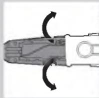
5 Чтобы извлечь внутренние детали, вставьте отвертку с плоским шлицем в указанное отверстие и приподнимите верхнюю крышку.
