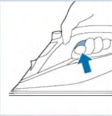
За счет более интенсивного проникновения пара в ткань функция “Паровой удар” помогает разгладить самые устойчивые замятые складки.
