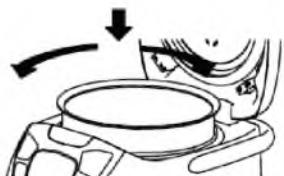
Вытрите насухо внутренний резервуар, а затем поместите его внутрь устройства, осторожно поверните его влево и вправо, чтобы убедиться, что внутренний резервуар плотно установлен на нагревательную поверхность.
