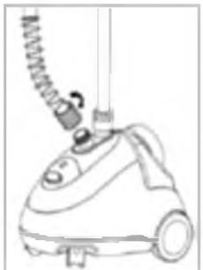
Вставьте гибкий шланг в паровыпускное отверстие и крепко закрутите гайку фиксации шланга.
