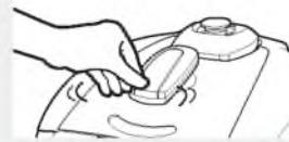
Поверните рычаг затвора в положение «**ЗАКРЫТО**» – на панели загорится красный индикатор. При попытке запустить мультиварку при открытом затворе «Голосовой гид» оповестит вас об ошибке.
