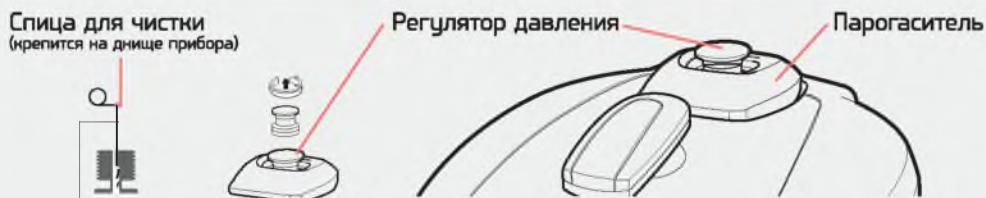
Поверните ручку закрытия крышки в положение «Закрыто», после чего приподнимите регулятор давления и, вращая против часовой стрелки, снимите его. С помощью спицы очистите канал и установите регулятор давления, вращая его по часовой стрелке до момента, когда он провалится и будет свободно двигаться.
