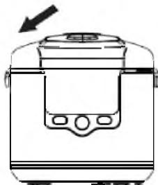
4. Установите алюминиевую крышку на место (если она снималась) и убедитесь, что она зафиксирована. Затем плотно до щелчка закройте верхнюю крышку прибора. Если верхняя крышка будет закрыта недостаточно плотно, это негативно скажется на результатах приготовления.
