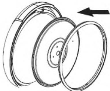
Установите алюминиевую крышку и уплотнительное кольцо обратно, как показано на рисунке. Прижмите алюминиевую крышку к внутренней крышке, чтобы зафиксировать ее. Затем установите уплотнительное кольцо. Если не получается сразу надеть уплотнительное кольцо, сначала закрепите его с одной стороны алюминиевой крышки и подвиньте в углублении ближе к центру, затем плавно натягивая уплотнительное кольцо вставьте оставшуюся его часть в углубление.
