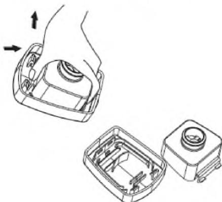
С небольшим усилием нажмите на задвижку крепления парового клапана, как показано на рисунке, затем потяните паровой затвор вверх. Извлеките уплотнительное кольцо из парового затвора и почистите его. При этом кольцо запрещается скручивать или вытягивать. Вымойте две части клапана проточной водой с применением мягких моющих средств, а затем вытрите насухо.
