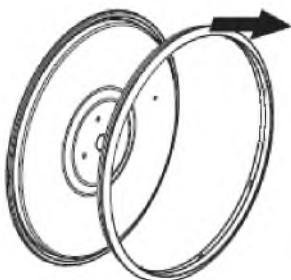
Вместе с алюминиевой крышкой вы также достанете уплотнительное кольцо. Аккуратно потяните его, чтобы отделить от крышки. Промойте крышку проточной водой с применением мягкого моющего средства, а затем вытрите насухо мягкой тканью.
