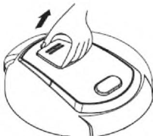
Снимите паровой клапан с верхней крышки, как показано на рисунке.
