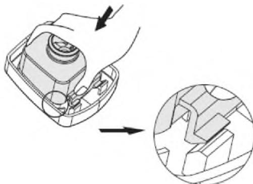
Затем установите уплотнительное кольцо обратно в паровой затвор и зафиксируйте паровой затвор в паровом клапане, как показано на рисунке (должен быть слышен легкий щелчок).
