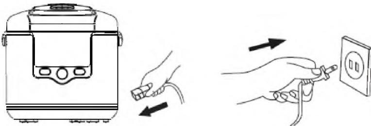
5. Подсоедините один конец кабеля питания к разъёму мультиварки, а вилку подключите к электрической розетке. После подключения к электросети индикатор работы прибора начнет мигать, а также загорится индикатор режима Обычный.
