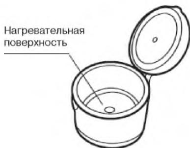
Иногда к нагревательной поверхности могут прилипнуть крупинки риса и другие частицы, что негативно сказывается на результатах приготовления. В случае сильного загрязнения почистите нагревательную поверхность мелкой наждачной бумагой (например, № 320), а затем мягкой сухой тканью.
