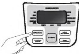
По окончании процесса приготовления раздастся звуковой сигнал, и мультиварка автоматически переключится в режим поддержания температуры готовых блюд: индикатор **ПЛОВ** погаснет, начнет мигать индикатор **ПОДДЕРЖАНИЕ ТЕПЛА**, дисплей покажет отсчет времени.
