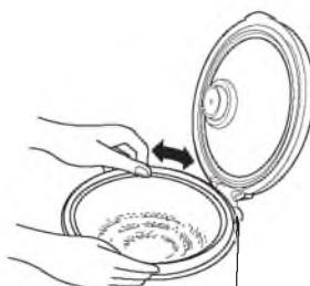
Вставьте чашу в корпус. Слегка поверните ее против часовой стрелки, убедитесь, что чаша плотно соприкасается с нагревательным элементом.
