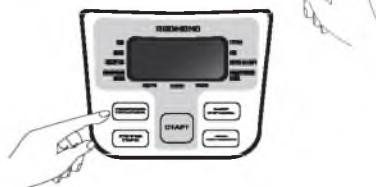
Время подогрева задается микропроцессором, процесс закончится автоматически, однако Вы можете его прервать, нажав на кнопку **ПОДДЕРЖАНИЕ ТЕПЛА/ОТМЕНА**
