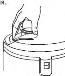
2. Полностью разберите клапан и тщательно промойте его под проточной водой, после чего тщательно просушите, соберите в обратной последовательности и установите на место.
