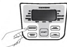
По окончании процесса приготовления раздастся звуковой сигнал, и мультиварка автоматически переключится в режим поддержания температуры готовых блюд: индикатор **МОЛОЧНАЯ КАША** погаснет, начнет мигать индикатор **ПОДДЕРЖАНИЕ ТЕПЛА**, дисплей покажет отсчет времени.
