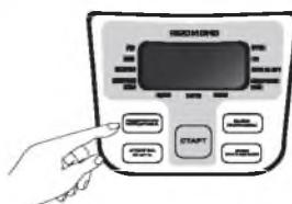
По окончании процесса приготовления раздастся звуковой сигнал, и мультиварка автоматически переключится в режим поддержания температуры готовых блюд: индикатор **ВАРКА НА ПАРУ** погаснет, начнет мигать индикатор **ПОДДЕРЖАНИЕ ТЕПЛА**, дисплей покажет отсчет времени.
