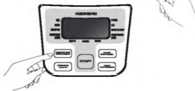
Время приготовления задается микропроцессором, процесс приготовления закончится автоматически, однако Вы можете его прервать, нажав на кнопку **ПОДДЕРЖАНИЕ ТЕПЛА/ОТМЕНА**. Среднее время приготовления – 50-60 мин.
