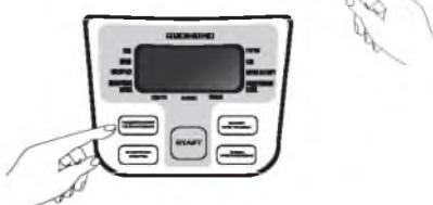
Время приготовления задается микропроцессором, процесс приготовления закончится автоматически, однако Вы можете его прервать, нажав на кнопку **ПОДДЕРЖАНИЕ ТЕПЛА/ОТМЕНА**
