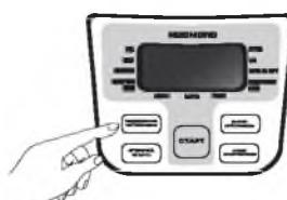
По окончании процесса приготовления раздается звуковой сигнал, и мультиварка автоматически переключится в режим поддержания температуры готовых блюд: индикатор **СУП** погаснет, начнет мигать индикатор **ПОДДЕРЖАНИЕ ТЕПЛА**, дисплей покажет отсчет времени.
