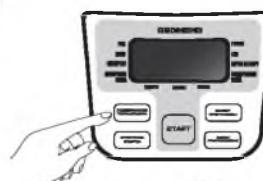
По окончании процесса приготовления раздастся звуковой сигнал, и мультиварка автоматически переключится в режим поддержания температуры готовых блюд; индикатор **ТУШЕНИЕ** погаснет, начнет мигать индикатор **ПОДДЕРЖАНИЕ ТЕПЛА**, дисплей покажет отсчет времени.
