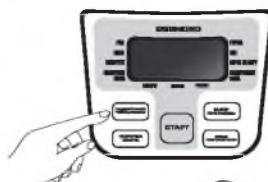
По окончании процесса подогрева раздастся звуковой сигнал и мультиварка автоматически переключится в режим поддержание температуры готовых блюд; индикатор **ПОДОГРЕВ** погаснет, начнет мигать индикатор **ПОДДЕРЖАНИЕ ТЕПЛА**, дисплей покажет отсчет времени.
