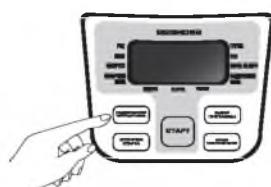
Время приготовления задается микропроцессором, процесс приготовления закончится автоматически, однако Вы можете его прервать, нажав на кнопку **ПОДДЕРЖАНИЕ ТЕПЛА/ОТМЕНА**
