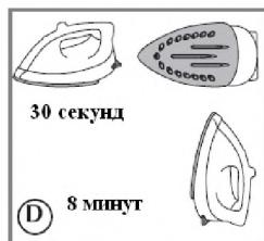
Функция автоматического выключения утюга действует следующим образом:
