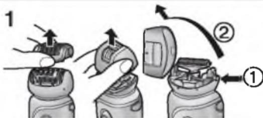
насадку для деликатной эпиляции/ насадку для начинающих, держась за выступ для снятия верхней части насадки [B③]/ выступ для снятия насадки для быстрой эпиляции, насадки для деликатной эпиляции, насадки для начинающих [BFB⑦] или снимите верхнюю часть бритвенной насадки, нажимая на кнопку снятия верхней части бритвенной насадки [B⑫].
