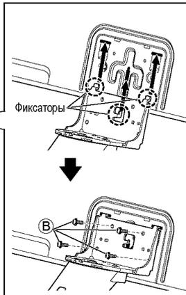
Выверните 3 выступа в кронштейне с отверстиями в задней части телевизора и закрепите.
