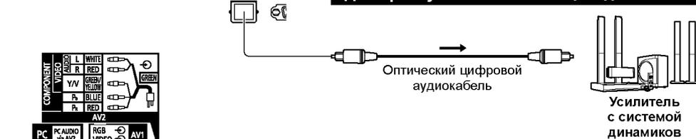
Для прослушивания многоканального звучания с внешнего оборудования (например, Dolby Digital 5.1ch) подсоедините оборудование к усилителю. Относительно подсоединения прочтите инструкции по эксплуатации оборудования и усилителя.
