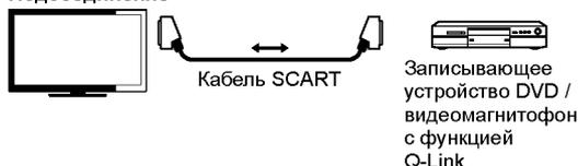
Используйте полностью экранированный кабель SCART. Подсоедините записывающее устройство DVD / видеомagneтoфон, поддерживающее функцию Q-Link, к разъему AV1 на телевизоре с помощью кабеля SCART.
