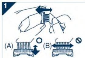
1. Очистка внутренних лезвий выполняется движением короткой щетки в указанном направлении (А). Очистка сетки, корпуса бритвенного станка и триммера выполняется с помощью длинной щетки.
