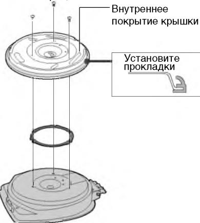
Снимите крышку, отвинтите 3 самореза и снимите с крышки внутреннее покрытие. Замените резиновые прокладки, а затем поместите на место внутреннее покрытие крышки и зафиксируйте ее саморезами.
