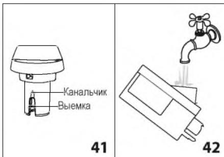
5. Ополосните гнездо для регулятора пены под проточной водой (рис. 42).
