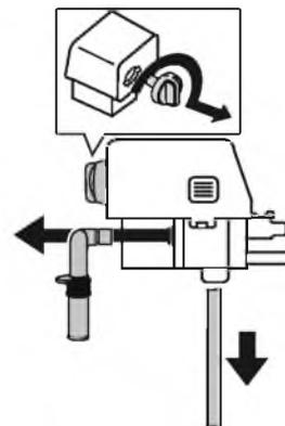
регулировки пены почасовой стрелке до положения "INSERT"(вставить)(см. рисунок) и потянуть ее вверх.
