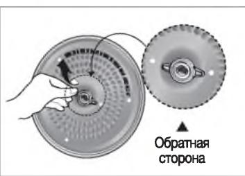
② Для очистки крышки, снимите крепёжную резиновую ручку. Сначала оттяните 2 резиновых выступа ручки с обратной стороны крышки, затем снимите ручку, потянув её с лицевой стороны. Снимите резиновую прокладку.
